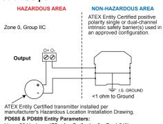
$V_{max}$ : 30 V;  $I_{max}$ : 175 mA;  $C_i$ : 0;  $L_i$ : 0;  $P_i$ : 1.0 W
