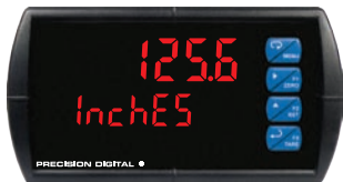
Modbus PV input
